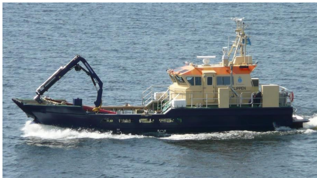
Figur 4:4. Bild av fartyget Klippen med dimensionerna längd 20 meter, bredd 6 meter samt höjd över vattenlinjen >7 meter, används till bland annat underhåll av farleder. Bildkälla: marinetraffic.com .
