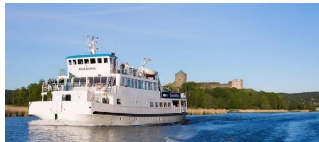
Figur 4:19. Bilder av fartyget Medvind med längd 32 meter, bredd 9,55 meter, djupgående 3,25 meter och höjd över vattenlinjen cirka 12 meter samt fartyget Trubaduren med längd 32,16 meter, bredd 10,35 meter, djupgående 2,2 meter samt höjd över vattenlinjen 11,8 meter.
