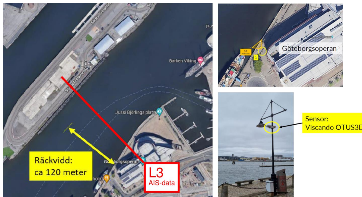
Figur 4:29. Satellitfoto med sensorn för båträknungen (kameran) placerad på Packhuskajen riktad mot Frihamnen. Placering av passagelinje L3 för AIS-data rödmarkerad i figuren. Bildkälla: Bilaga 1 – Studie: Bestämning av båthöjder.
