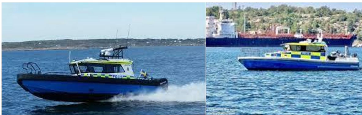
Figur 4:6. Bilder av Victor (till vänster) med dimensionerna längd 10,6 meter, bredd cirka 3 meter samt höjd <5,5 meter och Tryggve (till höger) med dimensionerna längd cirka 15 meter, bredd 4 meter samt höjd <5,5 meter. Bildkälla: hamnen.se .
