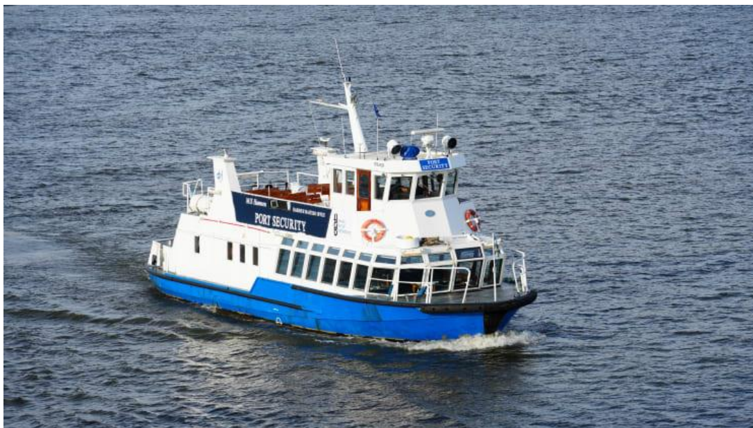
Figur 4:24. Bild av m/s Hamnen med fartygsdimensionerna längd 20,3 meter, bredd 5,7 meter och en höjd över vattenlinjen uppskattat >7 meter. Bildkälla: mynewsdesk.com/se/goteborgs-hamn/ .
