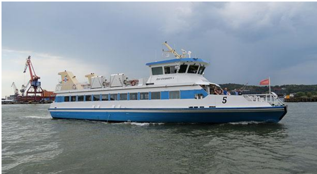
Figur 4:14. Bild av fartyget Älvsnabben 5 trafikerar sträckan Älvsnabben. Fartygsdimensioner: längd 32 meter, bredd 8,2 meter, höjd över vattenlinjen cirka 10 meter samt displacement cirka 150 ton. Bildkälla: stysobolaget.se .
