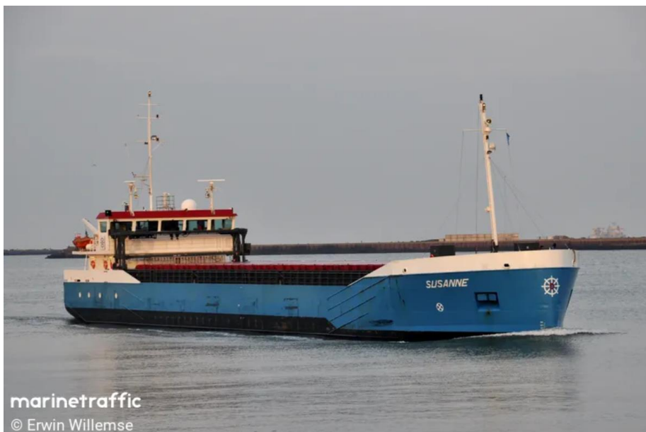
Figur 4:2. Bild av fartyget Susanne med dimensionerna längd 82,5 meter, bredd 12,5 meter kan fälla sina master så att hon får en höjd över vattenlinjen på max 10,5 meter och kan således passera under Hisingsbron utan öppning enligt kapitel 3.3.1.
