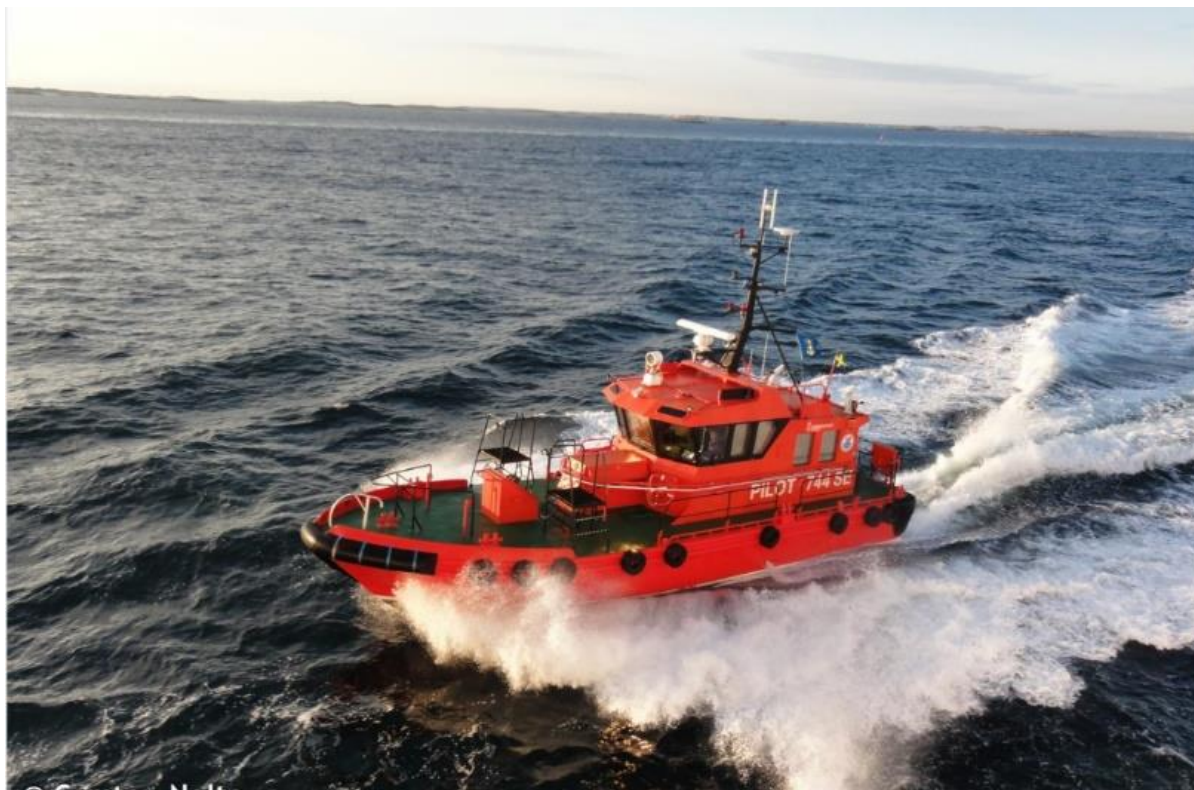
Figur 4:5. Bild av lotsbåten Pilot 744 SE med dimensionerna längd 17 meter, bredd 4 meter samt höjd över vattenlinjen >8 meter transporterar Sjöfartsverkets lotsar till och från de fartyg som ska ha lots. I Göteborgs hamn utgår lotsbåtarna från Tångudden väster om Älvsborgsbron. Bildkälla: fleetmon.com .
