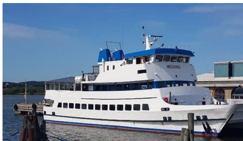
Figur 4:19. Bilder av fartyget Medvind med längd 32 meter, bredd 9,55 meter, djupgående 3,25 meter och höjd över vattenlinjen cirka 12 meter samt fartyget Trubaduren med längd 32,16 meter, bredd 10,35 meter, djupgående 2,2 meter samt höjd över vattenlinjen 11,8 meter.
