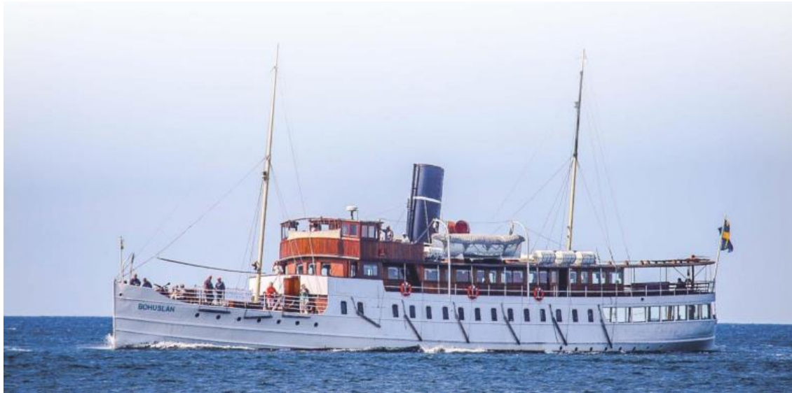
Figur 4:16. Bild av Ångaren Bohuslän med fartygsdimensioner: längd 43,13 meter, bredd 7,42 meter, djupgående 3,0 meter samt masthöjd över vattenlinjen 18 meter. Bildkälla: steamboat.se .
