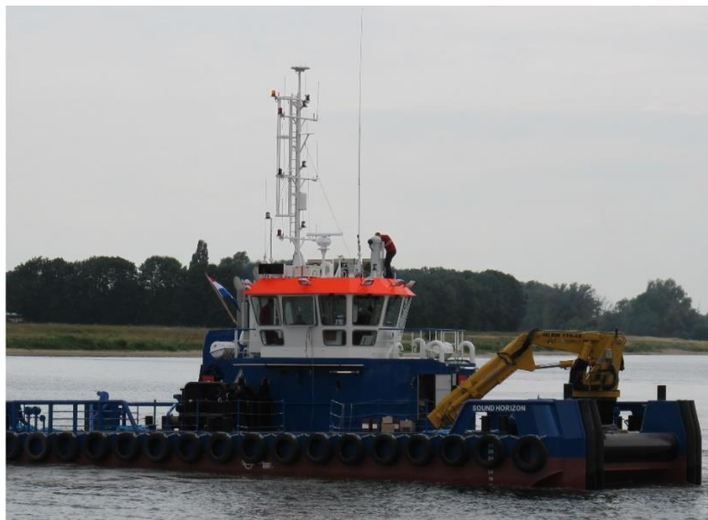
Figur 4:26. Bild av fartyget Sound Horizon med dimensionerna längd cirka 24 meter, bredd 9,5 meter och höjd över vattenlinjen 15 meter eller 8,25 meter med masten fälld, kan nyttjas till en stor mängd olika uppdrag. Bildkälla: sse-ab.se .
