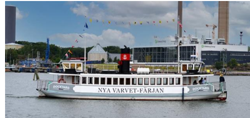
Figur 4:18. Bild av Färjan 4 och Nya Varvet (tidigare Djurgården 7) med fartygsdimensionerna längd 20,55 meter, bredd 5,4 meter, djupgående 2,35 respektive 1,8 meter samt en masthöjd över vattenlinjen 8,5 meter (data masthöjd endast för Färjan 4. Bildkällor: sjofartsmuseetakarier.se samt stromma.se
