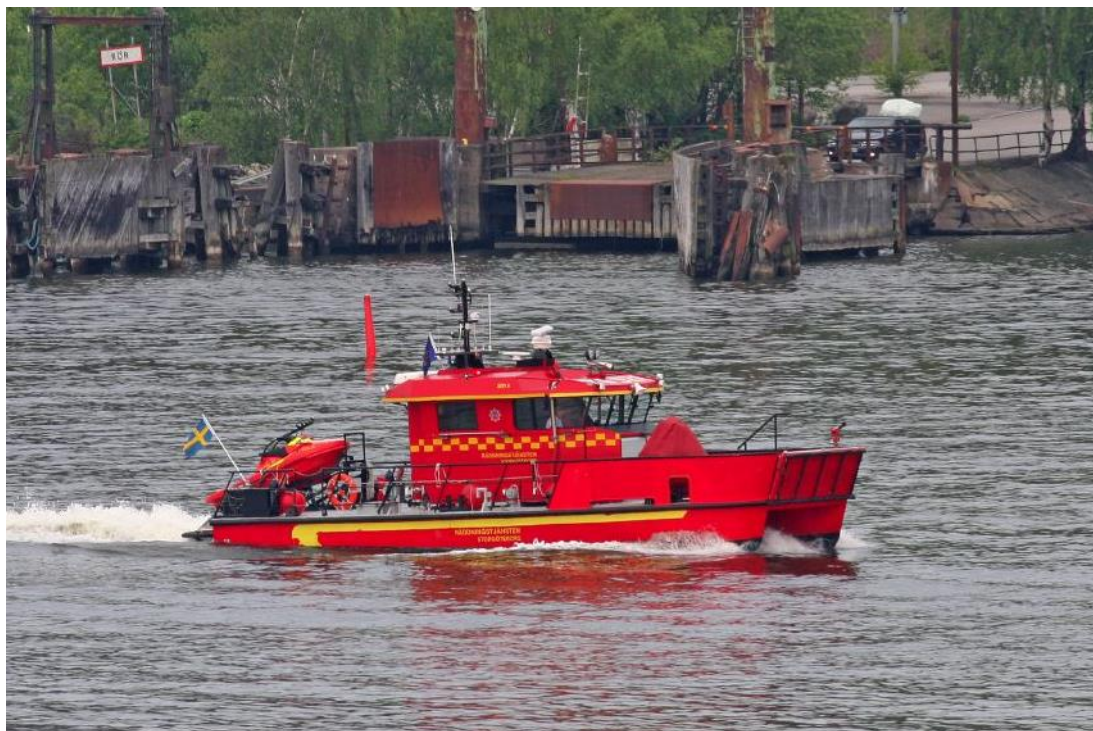
Figur 4:7. Bild av Räddningstjänsten Storgöteborgs fartyget Göte II med längd 15 meter och en höjd över vattenlinjen 5,55 meter. Bildkälla: lindhall.se .
