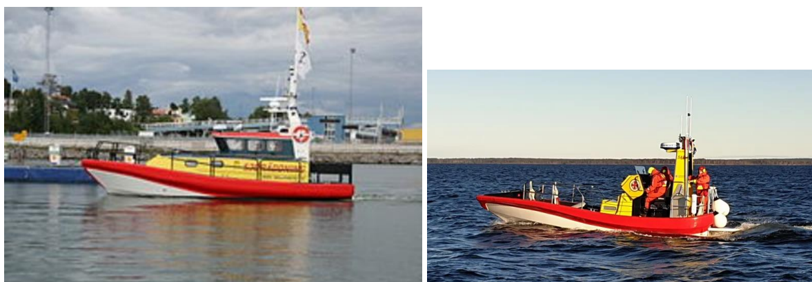
Figur 4:8. Två exempelbilder på SSRS:s fartyg. Viktoriaklassen till vänster med höjd <8 meter och Gunnel Larson-klassen med höjd <5 meter. Bildkälla: sjoraddning.se .
