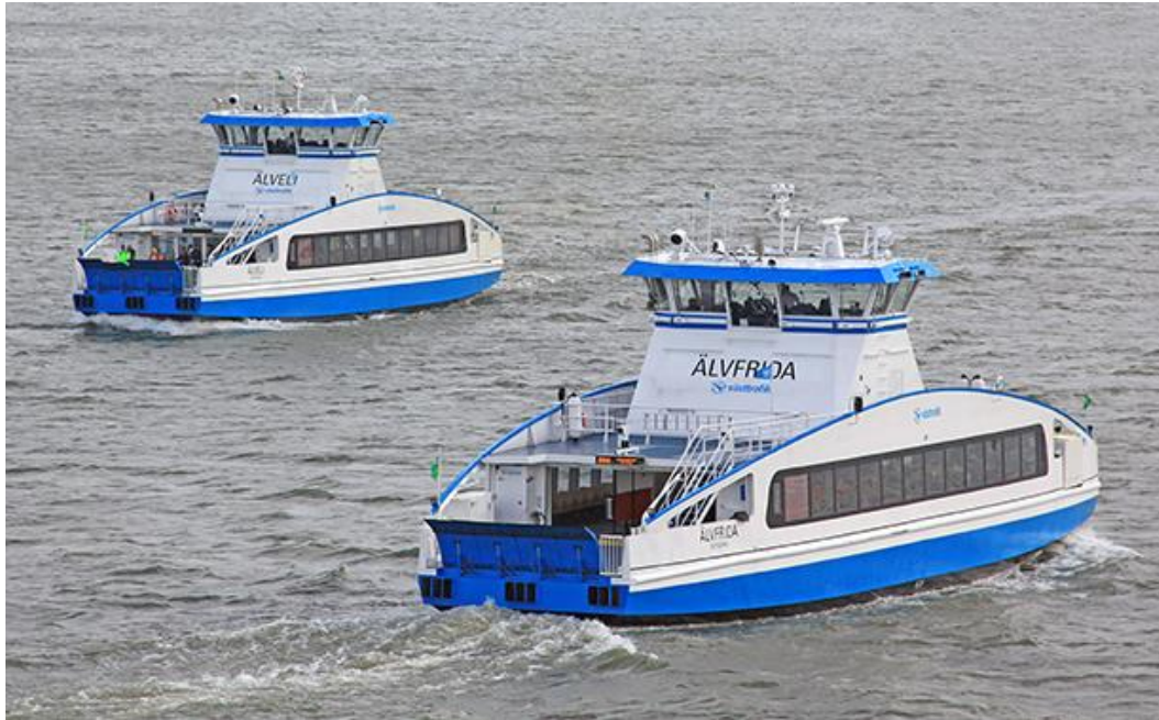
Figur 4:13. Bild av fartygen Älveli och Älvfrida trafikerar sträckan Älvsnabbare (linje 286). De har dimensionerna längd 33 meter, bredd 8,7 meter, höjd över vattenlinjen 12,9 meter samt displacement 172 ton. Bildkälla: stysobolaget.se .
