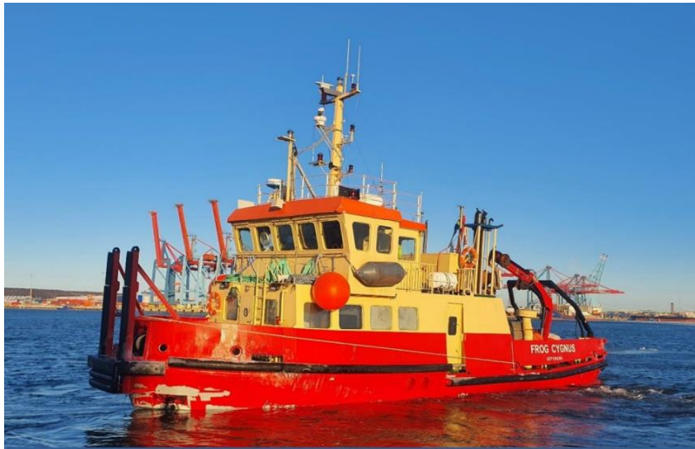
Figur 4:25. Bild av fartyget Frog Cygnus med dimensionerna längd 20,3 meter, bredd 6,05 meter och höjd över vattenlinjen >7 meter används bland annat till dykning och som bogserbåt. Bildkälla: sse-ab.se .
