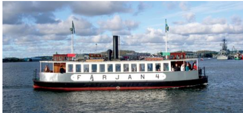
Figur 4:18. Bild av Färjan 4 och Nya Varvet (tidigare Djurgården 7) med fartygsdimensionerna längd 20,55 meter, bredd 5,4 meter, djupgående 2,35 respektive 1,8 meter samt en masthöjd över vattenlinjen 8,5 meter (data masthöjd endast för Färjan 4. Bildkällor: sjofartsmuseetakarier.se samt stromma.se
