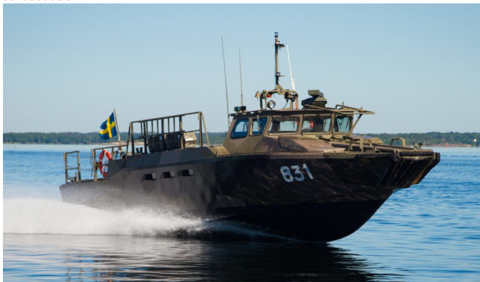
Figur 4:10. Bild av stridsbåt 90 H med en höjd över vattenlinjen 4,2 meter. Dessa fartyg har ej krav på AIS enligt Försvarsmaktens reglemente. Bildkälla: www.soldf.com .
